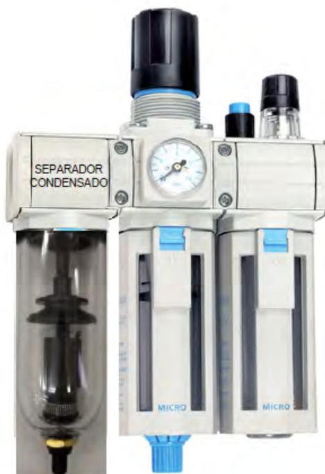
O dreno automático possui uma rosca macho G1/8", o que possibilita a adaptação de uma luva, de mesma bitola + conexão reta x tubo 6 ou 8 mm para canalizar a descarga do mesmo.
