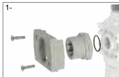
Kit adaptador de conexão, para G1/4", G3/8", G3/4" e G1"
