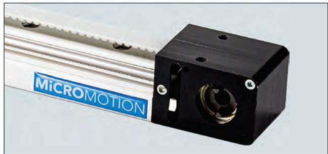
A linha de eixos elétricos Cargo 50 é movida por correia dentada e a carga é guiada por um sistema de rodízios sobre barras cilíndricas, possibilitando movimentos lineares rápidos e precisos. A linha Cargo 50 pode ser combinada com outras linhas de atuadores, formando sistemas cartesianos de manipulação.
