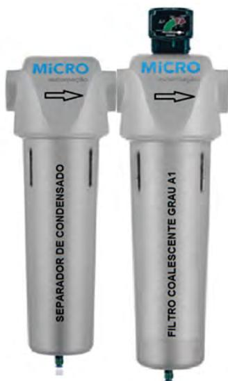
É recomendado instalar na entrada de um filtro coalescente GRAU A1 um separador de condensado SC. Esta condição aumenta a eficiência do filtro coalescente bem como a vida útil do elemento filtrante. A função do separador de condensado SC é eliminar a maior quantidade de condensado, particulado e mesmo óleo arrastadas pelo ar comprimido. Não observar o exposto acima propiciará o encharcamento do elemento filtrante diminuindo assim sua eficiência.
