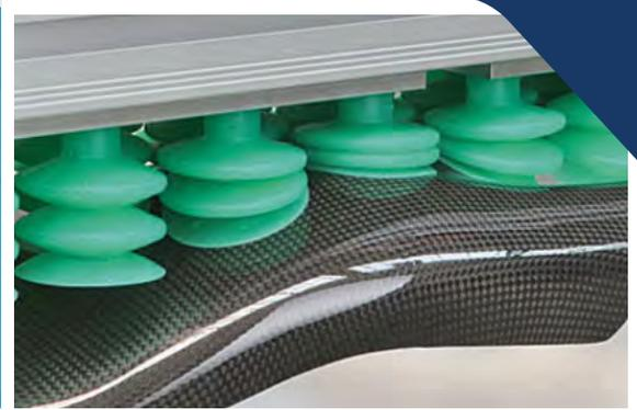
**Componente Versátil - Uma única unidade deste componente pode manipular uma infinidade de peças, pois sua estrutura de espuma ou ventosas tem a capacidade de se conformar às superfícies do objeto.**
