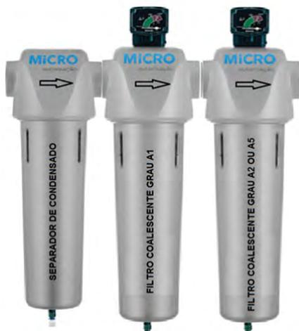
É recomendado instalar na entrada de um filtro coalescente GRAU A2 ou A5 ou carvão ativado GRAU A4 um separador de condensado SC + filtro coalescente GRAU A1. Esta condição aumenta a eficiência do filtro coalescente (Grau A2 ou A5) bem como a vida útil do elemento filtrante. Não observar o exposto acima propiciará o encharcamento do elemento filtrante diminuindo assim sua eficiência.
