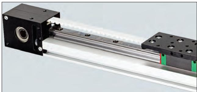
A linha de eixos elétricos Cargo 100 é movida por correia dentada e a carga é guiada por um sistema de patins sobre uma guia linear de 20mm de largura, possibilitando movimentos lineares suaves e precisos. Pode ser combinada com outras linhas de atuadores formando sistemas de manipulação com vários eixos de movimentação.
