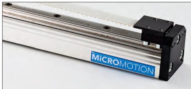
A linha de eixos elétricos Lift 50 é movida por correia dentada e a carga é guiada por um sistema de patins duplo sobre uma guia linear de tamanho 15mm, possibilitando movimentos lineares suaves.
