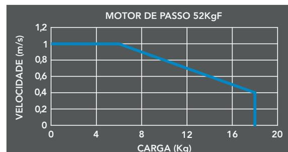
Observações: os dados apresentados nos gráficos acima foram extraídos de testes em laboratório realizados em condições de carregamento, onde os corpos de provas estão alinhados aos centros de gravidade das mesas dos atuadores. Os testes foram realizados com os atuadores na posição horizontal. Estes valores são orientativos e podem variar de acordo com as dimensões da carga, posição do atuador e outros fatores externos. A aceleração e desaceleração foi padronizada em 0,2 segundos nos testes.
