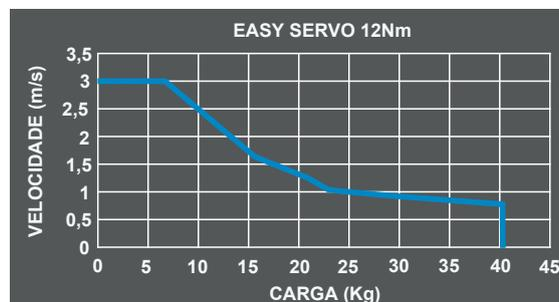
Observações: os dados apresentados nos gráficos acima foram extraídos de testes em laboratório realizados em condições de carregamento, onde os corpos de provas estão alinhados aos centros de gravidade das mesas dos atuadores. Os testes foram realizados com os atuadores na posição horizontal. Estes valores são orientativos e podem variar de acordo com as dimensões da carga, posição do atuador e outros fatores externos. A aceleração e desaceleração foi padronizada em 0,2 segundos nos testes.
